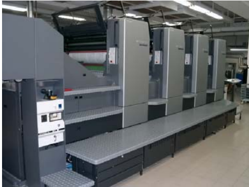
6. ábra: Ofszet nyomdagép (Forrás: Klinghammer I.- Mosonyi L.- Török Zs. (szerk.): Amiről a térképek mesélnek CD-ROM)
