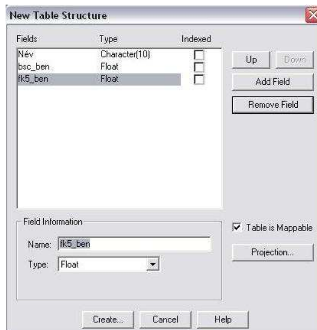
3.2.8. ábra: új táblaszerkezet létrehozása
