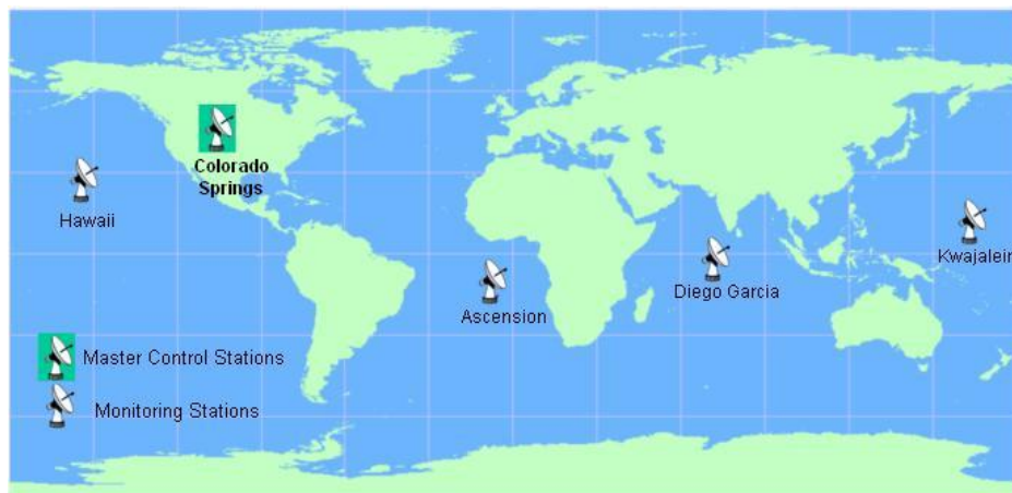
5. ábra: A GPS vezérlőközpontok a Földön. Coloradóban található a fő vezérlőközpont
