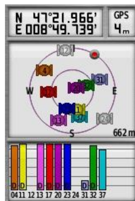
7. ábra: A készülék képernyőjén ilyen módon jelennek meg az érzékelt műholdak, valamint azok jelerőssége
