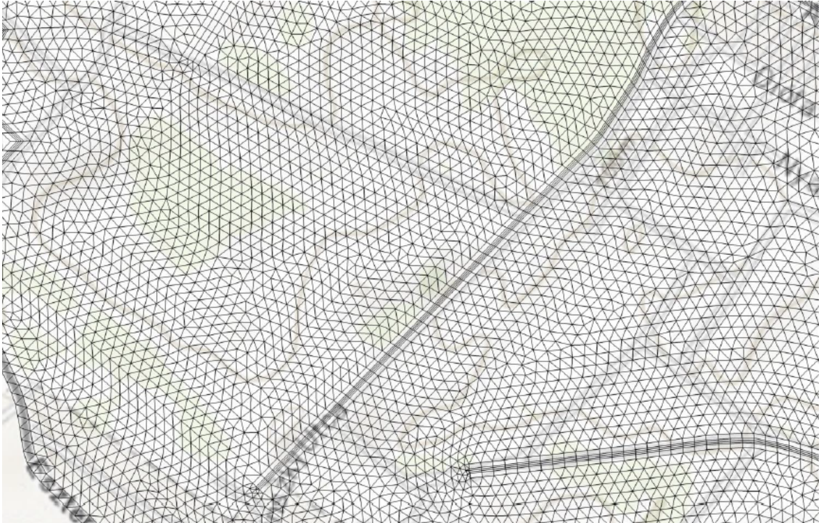
52. ábra: Számítási rácsháló részlete a pilismaróti belterületen, 30 m rácsebontással
