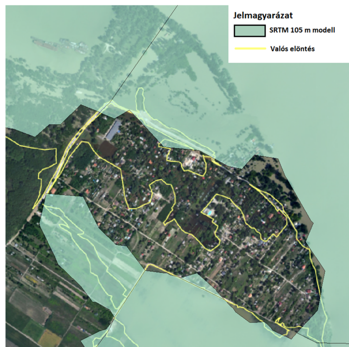
48. ábra: Az SRTM 105 m lefolyásmodell jól konvergál a valódi elöntéshez
