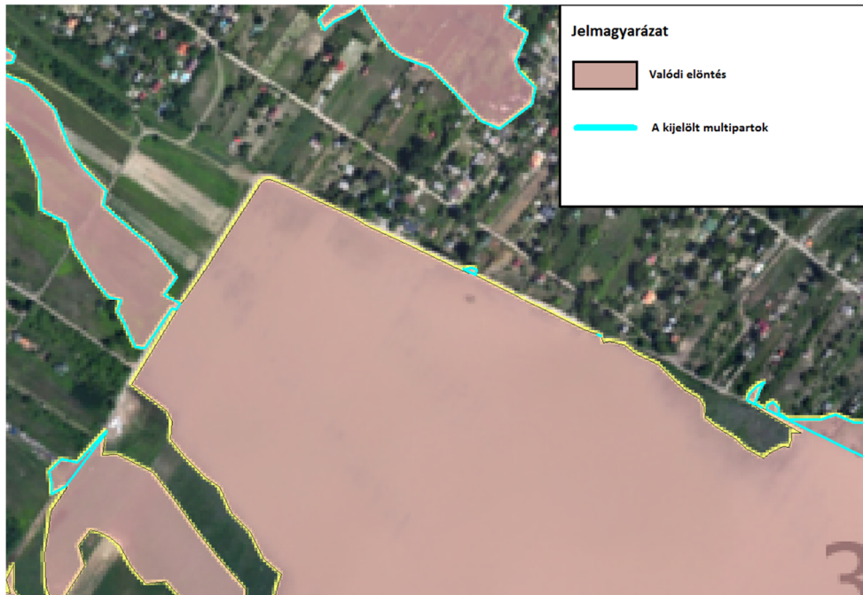
39. ábra: Az Editor eszköztár Merge eszközével egyesítettem az egybetartozó poligonokat
