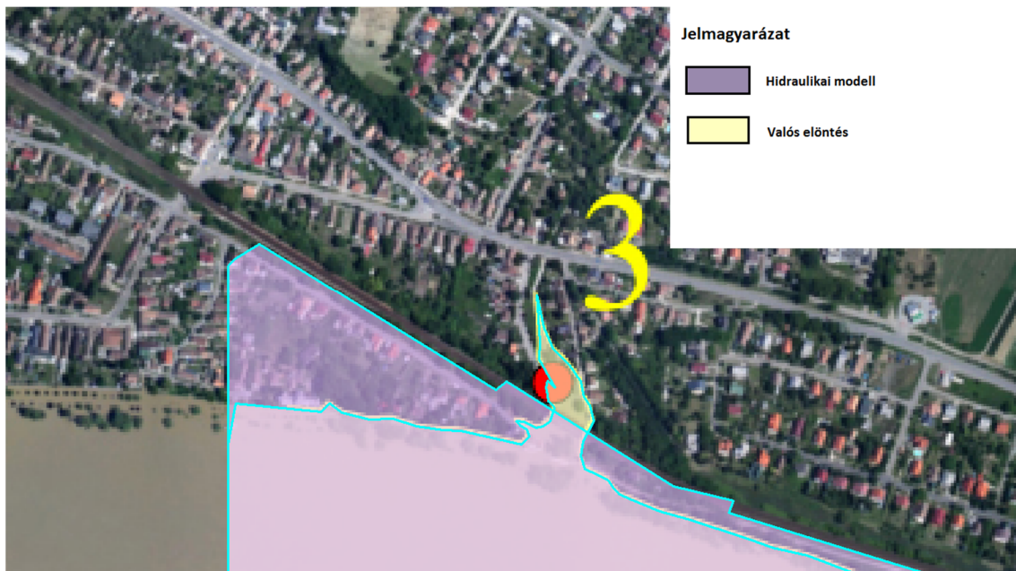
44. ábra: A modellezett és a valódi elöntés közti különbség a szobi Duna-parton: a lila színnel a modellezett, sárga színnel a valódi elöntés látható
