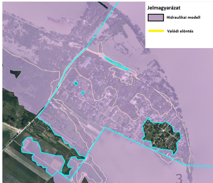
46. ábra: Az üdülőterület hidraulikailag modellezett (lila felületszínezéssel) és valódi (sárga kontúrral) elöntése
