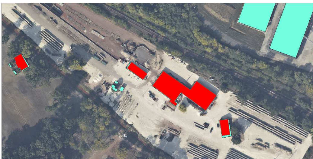
15. ábra: Épületpoligonok átfedése (Kék: új felmérés épülete, piros: tavaly elöntött kategóriájú épület)
